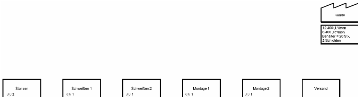
Abb. 3.8 Schneller Durchgang zur Identifikation der Reihenfolge der Prozesse (in Anlehnung an Rother/Shook, 2006, S. 20 – 21)
